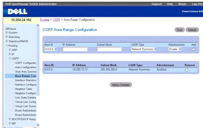
Abbildung 10-9. Konfiguration des Adressbereichs eines OSPF-Bereichs
