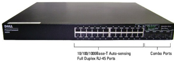
Abbildung 2-1. PowerConnect 6224 mit 24 10/100/1000-Base-T-Ports
